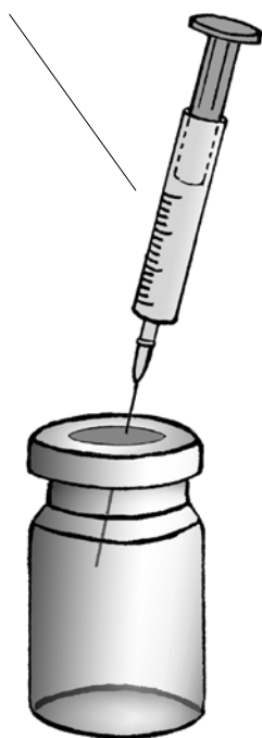
Fig. 5 > Travaso del campione di aria interstiziale in una vial evacuata per l'analisi dello spazio di testa
