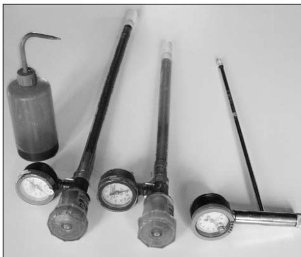
Fig. 47 - Tensiometri a manometro di diverse lunghezze e tipologie con accessori
