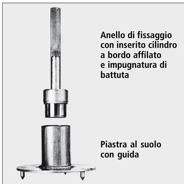
Fig. 48 - L'illustrazione mostra un set di prelievo da 100 ml.
