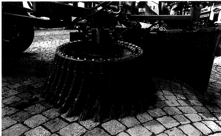
Le sarchiatrici a spazzola ruotante permettono di combattere direttamente le piante ai bordi delle strade che non possono essere tollerate. Con questo modello di spazzola di cavi d'acciaio si elimina la vegetazione alta, ad esempio prima di procedere al risanamento delle opere stradali.
