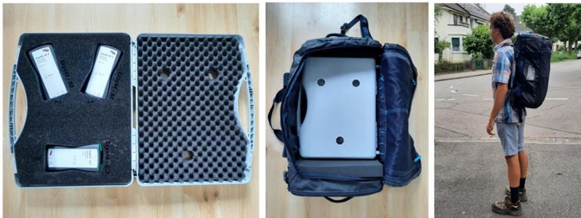
Figura 2: Figura della configurazione per la misurazione sui percorsi. A sinistra: Tre dispositivi di misurazione (due ExpoM-RF4 e un ExpoM-ELF) sono fissati in una valigia riempita di schiuma. Al centro: la valigetta viene inserita nello zaino e fissata con la schiuma. A destra: la persona addetta alla misurazione porta lo zaino con i dispositivi di misurazione a una distanza di 20 cm dal corpo e a un'altezza di 160 cm.
