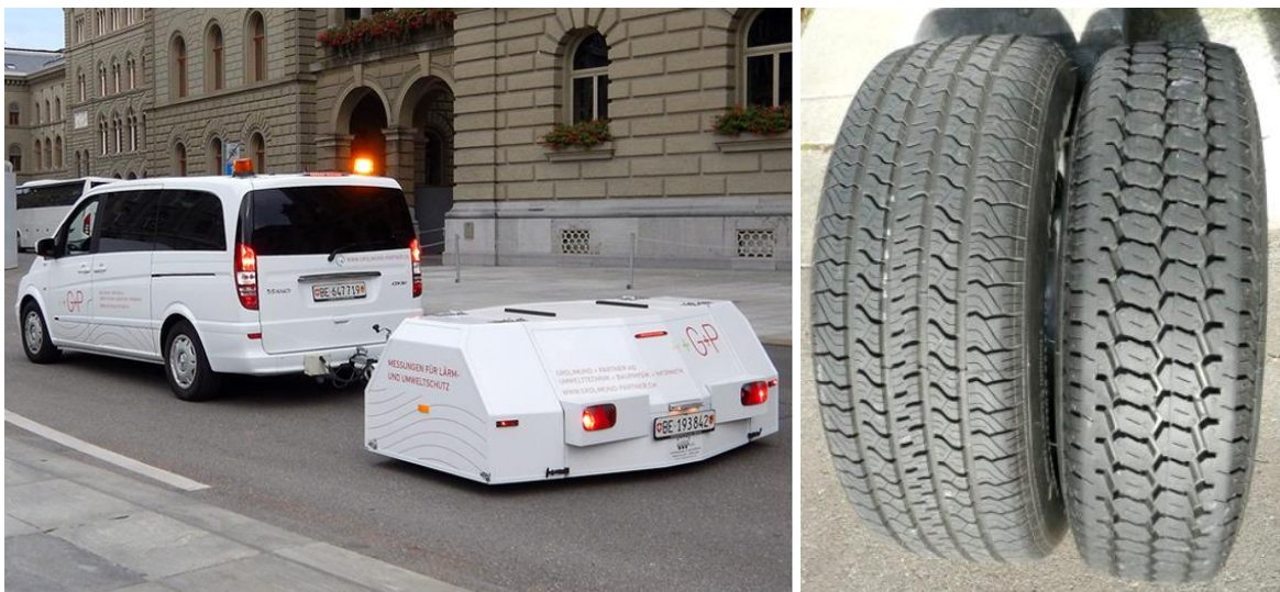
Abbildung 11: G+P Messsystem und CPX-Testreifen P1 (links) und H1 (rechts) gemäss ISO TS 11819-3:2017.
