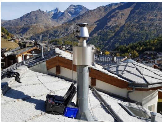
Misurazione delle emissioni a Saas-Fee (Nemo Lohberger / FHNW)
