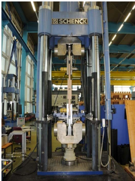
Abbildung 3: Vorversuche an Lamellenstössen (links) und an einem Auflagerbereich (rechts)
