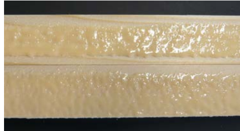
Abbildung 14: Mischkammer Nr.3 oben ohne Luft, unten mit Luftunterstützung
