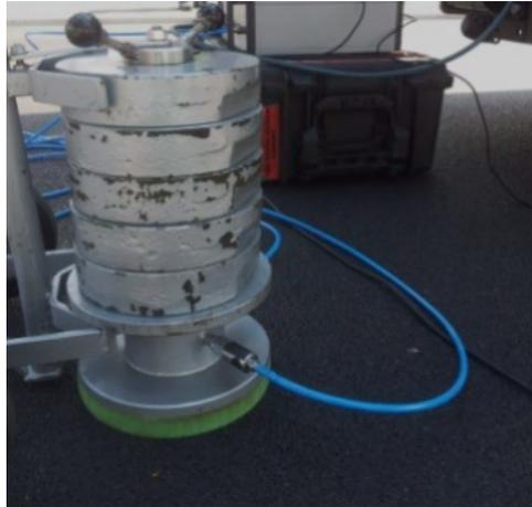
**Abbildung 2.4:** Lufttopfmessgerät der IMP Bautest AG.
