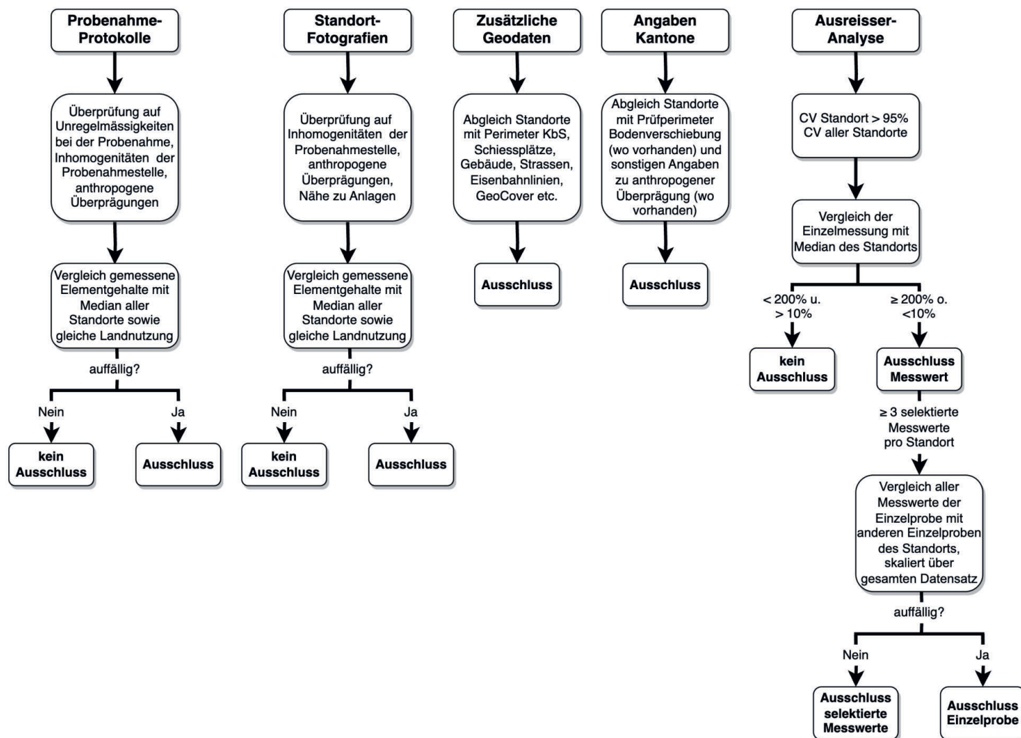
Abbildung 6 | Schematische Darstellung des Ausschlussverfahrens (KbS: Kataster der belasteten Standorte, CV: Variationskoeffizient).
