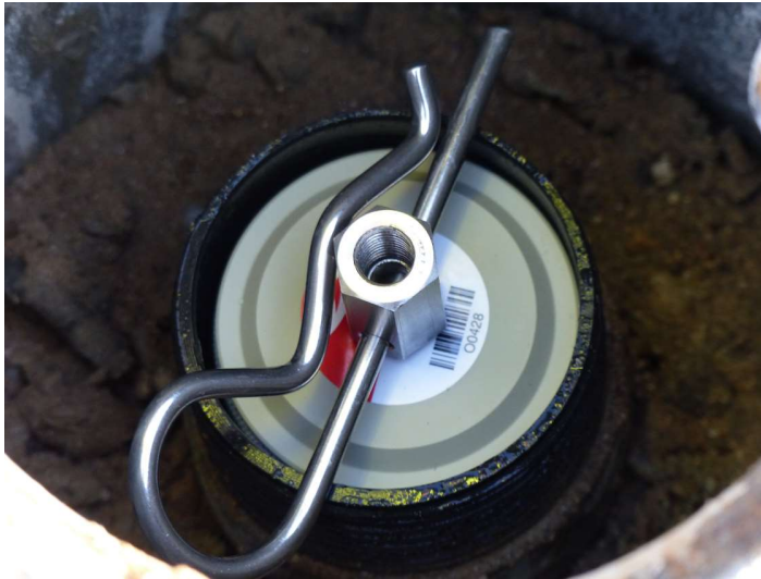
Goupille permettant de tenir les PFM en cours d'installation
