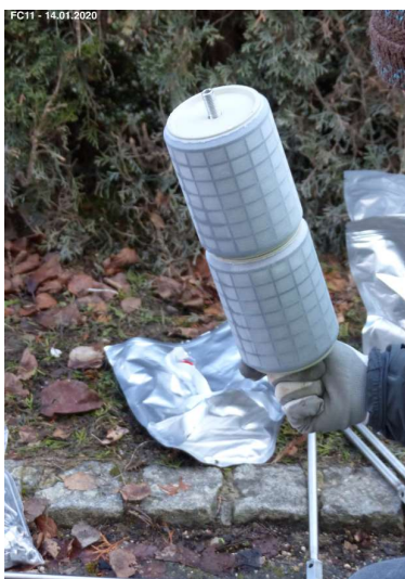
Cartouches PFM COV et Darcy (4.5") installés sur une tige 33 cm
