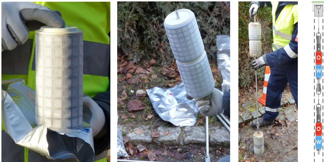
Figure 2 Cartouches PFM utilisées pour mesurer les flux de Darcy et les flux massiques d'HCC.
