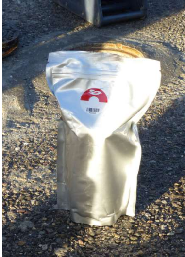
Cartouche PFM COV dans son emballage d'origine de plastique aluminisé fermé hermétiquement. Diamètre 3", hauteur 15 cm.
