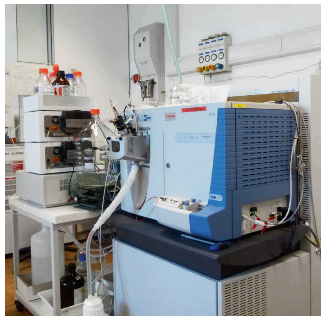
Fig. 6 An diesem HPLC-HRMS-Gerät werden die jeweils am Morgen gezogenen Sammelproben gemessen.
