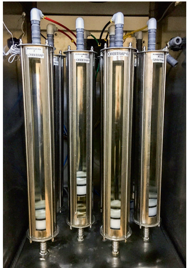
Fig. 5 Dieser Probenehmer wurde eigens für die HPLC-HRMS-Analytik entwickelt. Die kontinuierliche Probenahme erfolgt ohne Kontakt zur Umgebungsluft.
