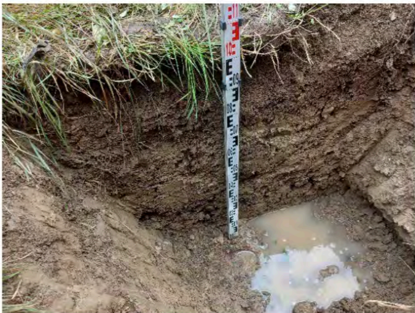
Fosse pédologique S6. Sol urbain reconstitué profond sur remblai de colluvions et moraines relativement meuble. Forte rupture de continuité hydraulique en partie inférieure de profil (-100/-110cm).
