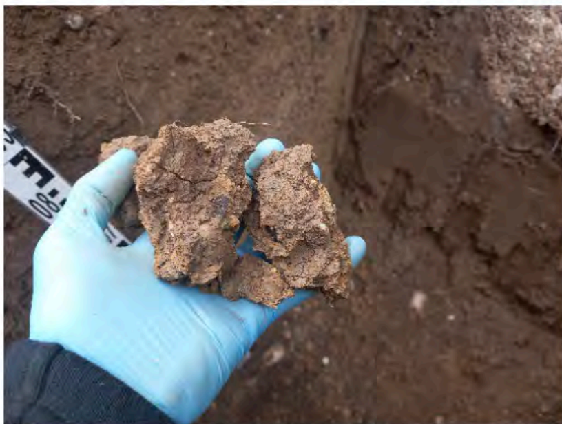
Fosse pédologique S3. Exemple de motte très difficile à fragmenter, faible porosité, faces angulaires, sol compacté, racines à l’extérieur des mottes uniquement (Remblai de colluvions et moraine : SubVESS Ssq4).
