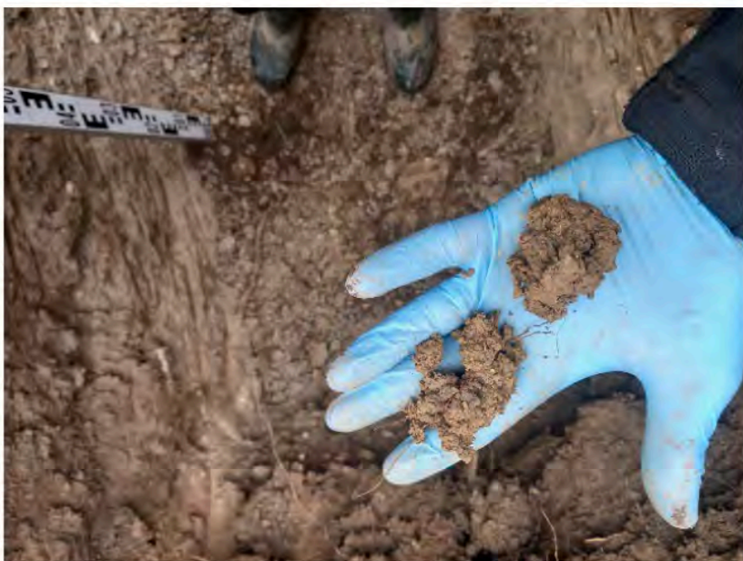
Fosse pédologique S5. Exemple de motte facile à fragmenter, assez poreuse, traversée par les racines, tassement léger n’a que peu d’influence sur les racines (Remblai de colluvions : SubVESS Ssq2).
