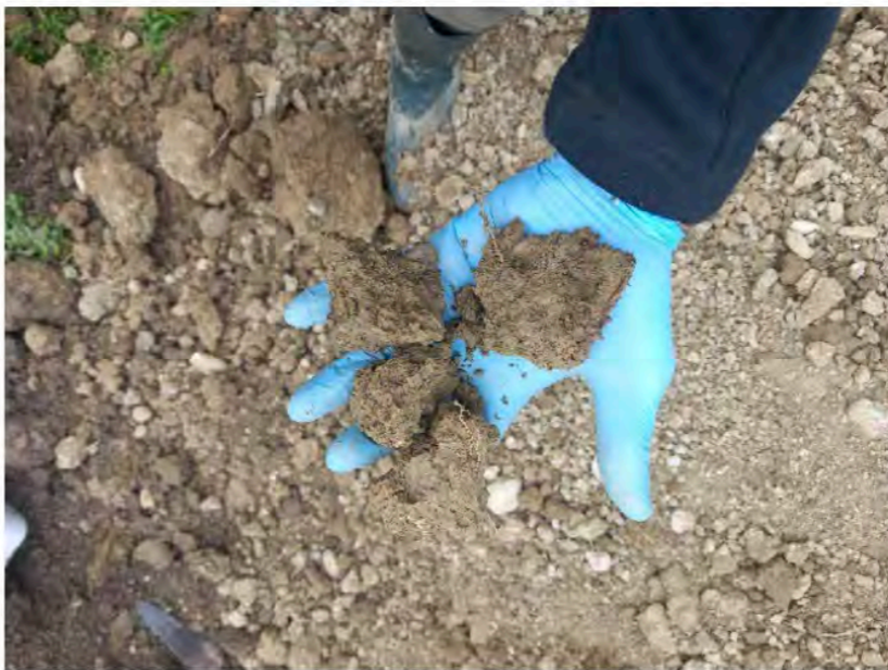
Fosse pédologique S1. Exemple de motte plus difficile à fragmenter, porosité réduite, difficilement traversée par les racines, quelques faces angulaires, sol tassé à compacté (Remblai de colluvions : SubVESS Ssq3).
