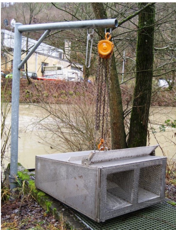
Kastenreuse aus Lochblech mit Hebevorrichtung (AquaPlus)
