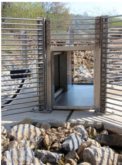
Riverwatcher mit Kameramodul (I AM HYDRO)
