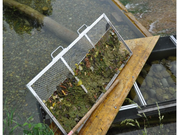
Von Algen verlegtes (oberes) Gitter im Sommer (Baier)
