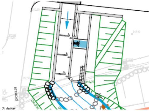
Aufstiegshilfe wird während der Erfolgskontrolle mittels Schieber geschlossen und die Fische ins Zählbecken geleitet (Gebler)
