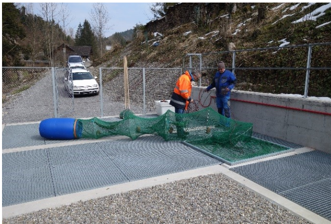
Netzreuse mit Fangfass zur Strömungsreduktion (AquaPlus)
