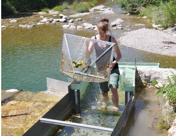
Einsetzen des unt. Gitters mit Kehle in die Steffstep (Baier)
