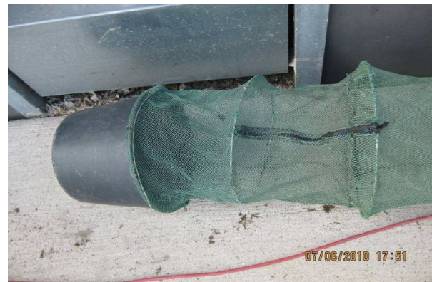
Fangkasten mit Hamen, Reuse, eingebautem Eimer und Reissverschluss zur Fischentnahme (Schmalz 2010)
