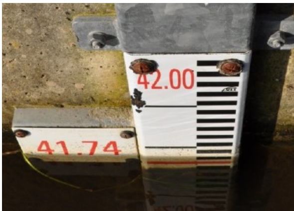
Abb. 5: Anhand in der Anlage angebrachter Markierungen oder Messlatten können verschiedene Parameter leichter überprüft werden. Durch periodisches Leeren der Anlage kann der Zustand der Gesamtanlage überprüft werden (Aquarius)
