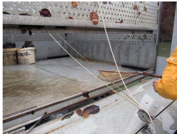
Entleerung der Reuse durch Aufklappen der Seitenwand (Fischwerk)
