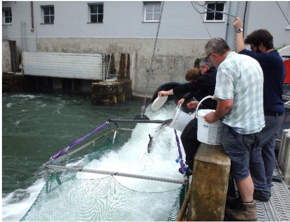
Einbringen von Fischen in Hamen resp. in Bypass bei Abstiegsversuch (Aquarius)
