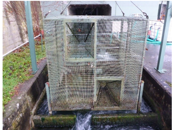
Reuse mit Reusenkehlen (Aquatica)
