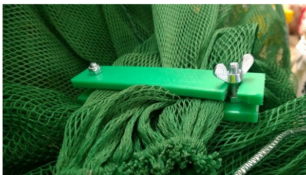
Hamenverschluss für einfaches Handling (Froelich Mechanische Werkstatt AG)
