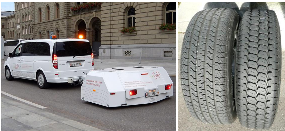
Abbildung 1: G+P Messsystem und CPX-Testreifen P1 (links) und H1 (rechts) gemäss ISO TS 11819-3:2017.
