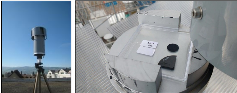
Abbildung 23: links: Sigma-2 Passivsammler; rechts: Haftoberfläche mit verschiedenen Substraten (Bor: unten rechts, C-Pad: oben rechts und Glasoberfläche: links).
