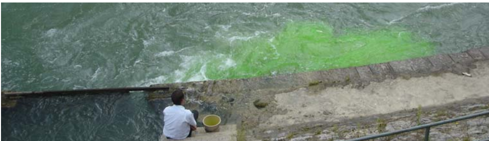
Abb. 17 > Färbversuch mit Uranin beim Einstieg des Beckenpasses beim Kraftwerk Wyhlen ca. 12 s nach Einbringen der Substanz im untersten Becken
