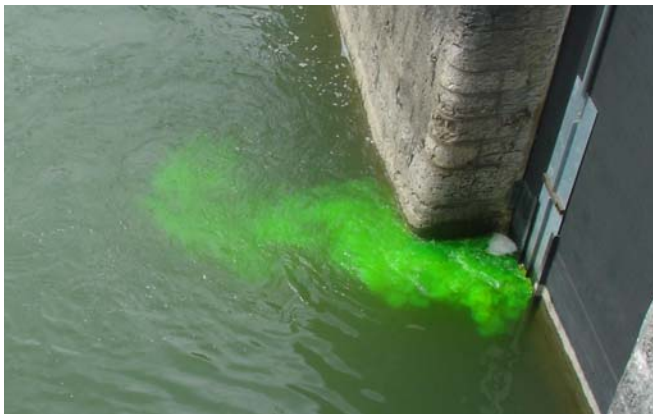
Abb. 18 > Färbversuch mit Uranin beim Einstieg des Fischlifts beim Kraftwerk Wyhlen ca. 4 s nach Einbringen der Substanz im Becken oberhalb der Einstiegöffnung
