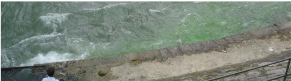
Abb. 17 > Färbversuch mit Uranin beim Einstieg des Beckenpasses beim Kraftwerk Wyhlen ca. 12 s nach Einbringen der Substanz im untersten Becken
