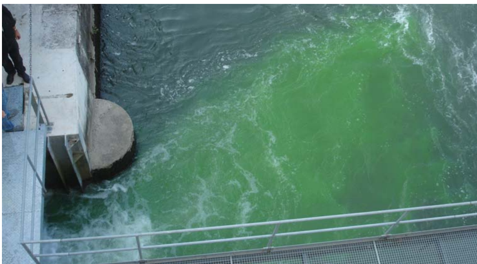
Abb. 14 > Färbversuch mit Uranin beim Einstieg der FAH des Kraftwerks Augst ca. 12 s nach Einbringen der Substanz im untersten Becken
