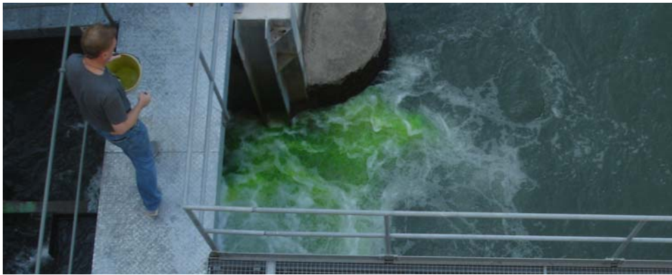
Abb. 14 > Färbversuch mit Uranin beim Einstieg der FAH des Kraftwerks Augst ca. 12 s nach Einbringen der Substanz im untersten Becken
