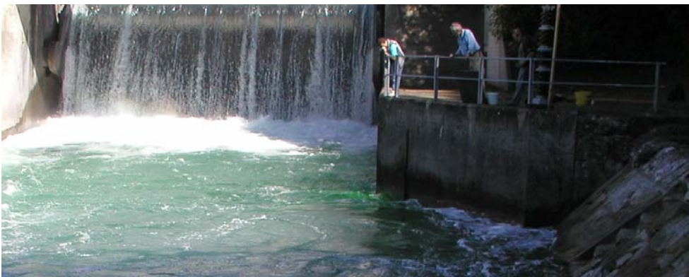
Abb. 8 > Färbversuch mit Uranin beim Einstieg der FAH des Kraftwerks Schaffhausen ca. 4 s nach Einbringen der Substanz im untersten Becken
