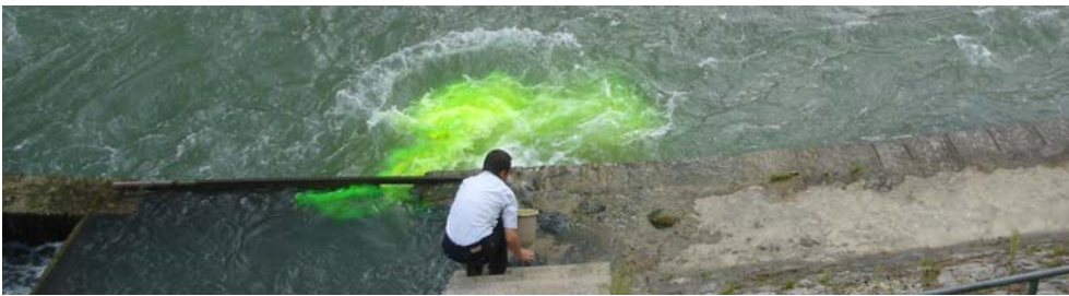
Abb. 16 > Färbversuch mit Uranin beim Einstieg des Beckenpasses beim Kraftwerk Wyhlen ca. 4 s nach Einbringen der Substanz im untersten Becken
