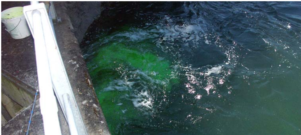
Abb. 10 > Färbversuch mit Uranin beim Einstieg der FAH des Kraftwerks Schaffhausen ca. 15 s nach Einbringen der Substanz im untersten Becken
