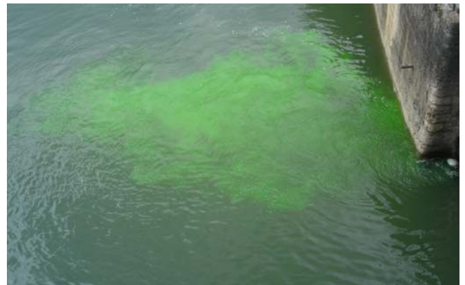
Abb. 19 > Färbversuch mit Uranin beim Einstieg des Fischlifts beim Kraftwerk Wyhlen ca. 12 s nach Einbringen der Substanz im Becken oberhalb der Einstiegöffnung
