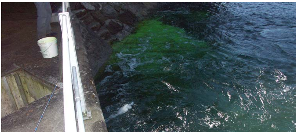
Abb. 10 > Färbversuch mit Uranin beim Einstieg der FAH des Kraftwerks Schaffhausen ca. 15 s nach Einbringen der Substanz im untersten Becken
