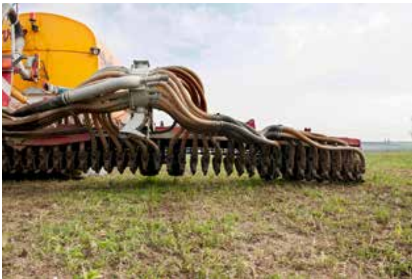
Der Gülledrill ist eine emissionsarme Technik zur Verteilung der Gülle. Der Ammoniakausstoss ist nur halb so gross wie bei der Ausbringung mit einem Prallteller.
