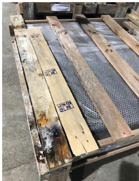
Abb. 5.2.1 Holzverpackungen mit deutlichem Pilzbefall.
