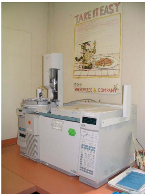
Foto 6: GC/MSD (Gaschromatograph gekoppelt mit Massenspektrometer)
