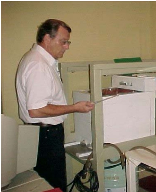
Foto 4: Neutronenaktivierungsanalyse/Messung: Zwecks Personenschutz wird die aktivierte Probe mit einer langen Zange in das geöffnete Gamma-Spektrometer eingeführt. Die dicke Bleiummantelung schirmt die Messkammer vor äußerer Fremdstrahlung ab. Die 15-minütige Messung erfolgt durch den am Boden der Ummantelung befindlichen Germanium-Detektor, der die elementspezifischen Energielinien der aktivierten Proben (Radionukleid-Zerfall) misst. Unter dem Spektrometer befindet sich der für die Kühlung des Germanium-Detektors erforderliche flüssige Stickstoff.
