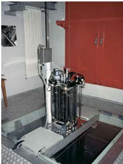
Foto 2: Neutronenaktivierung: Reaktoraufsatz für Steuerung und Probeneinführung
