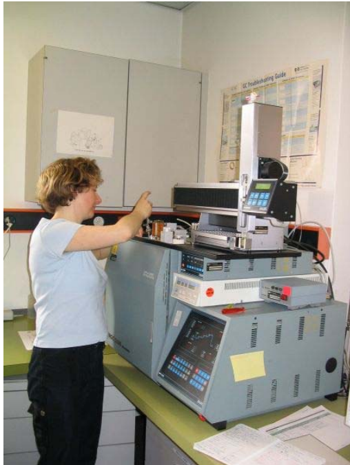
Foto 5: GC/ECD (Gaschromatograph mit Elektronen- einfangdetektor), Injektion einer Probe
