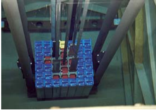
Foto 3: Neutronenaktivierung: Blick auf den Reaktorkern mit den Brennelementen
