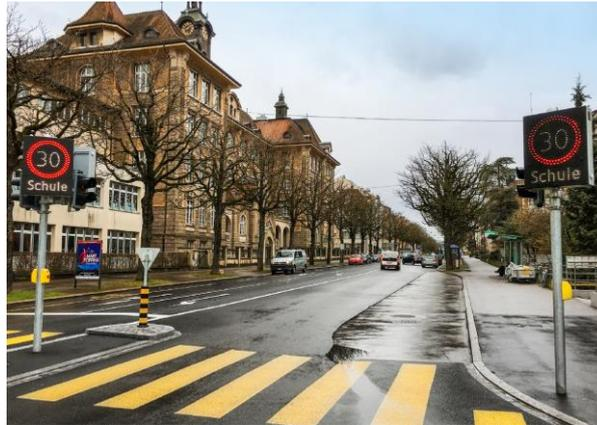
**Abb. 6** Signalisation von T30 zu bestimmten Zeiten; Beispiel mit einem elektronischen Wechselsignal, das zu Schulzeiten eingeschaltet wird. [102]
