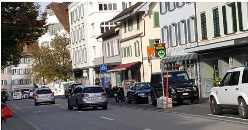
**Abb. 21** Wiederholung der Bodenmarkierung nach dem Fussgängerübergang und Geschwindigkeitsanzeige (Speedy) in Fahrrichtung Kolinplatz [Foto Basler & Hofmann AG]
