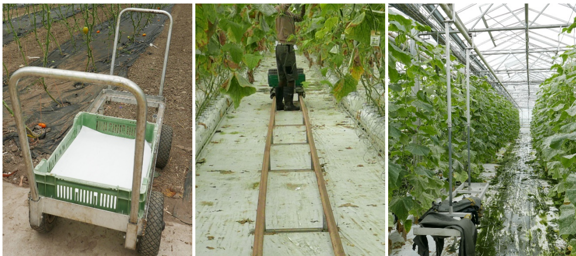
Abbildung 1: In den untersuchten Gewächshäusern verwendete Systeme für den Transport des Erntegutes: Erntewagen mit luftgefüllten Pneus (links), Rohrschienenwagen (Mitte), Monorail-Wagen (rechts).
