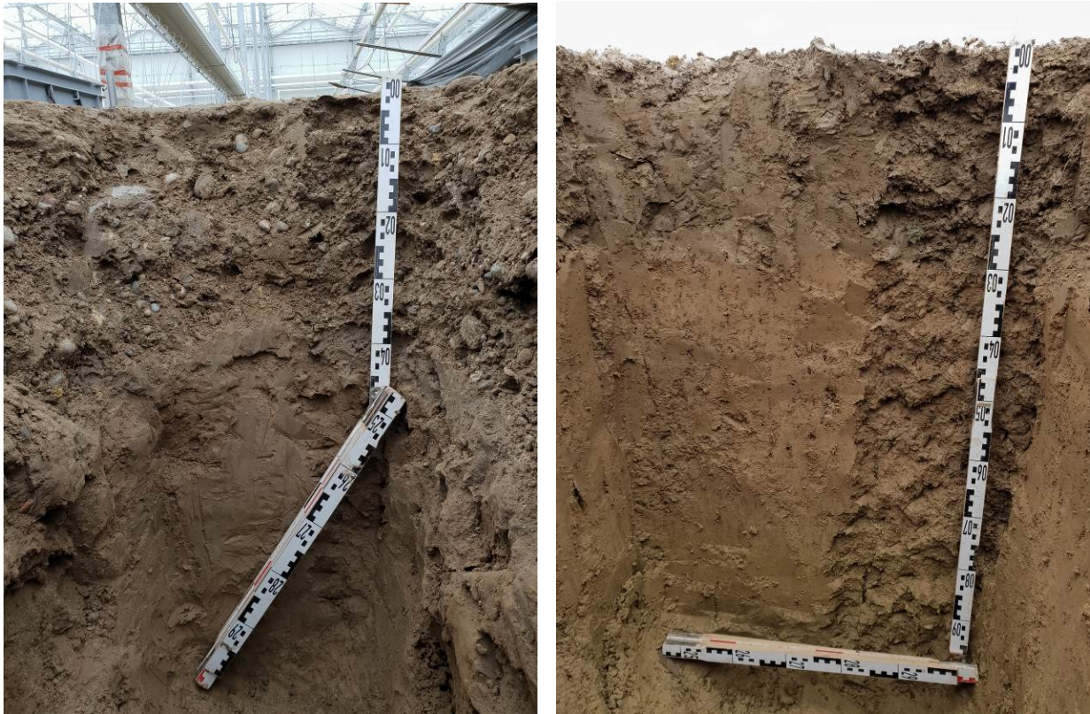
Abbildung 3: Bodenprofile am Standort 3. Gewächshausboden links, Boden der Referenzfläche rechts. Auf der linken Abbildung ist deutlich die Überschüttung zu sehen, die im Gewächshaus gemacht wurde.
