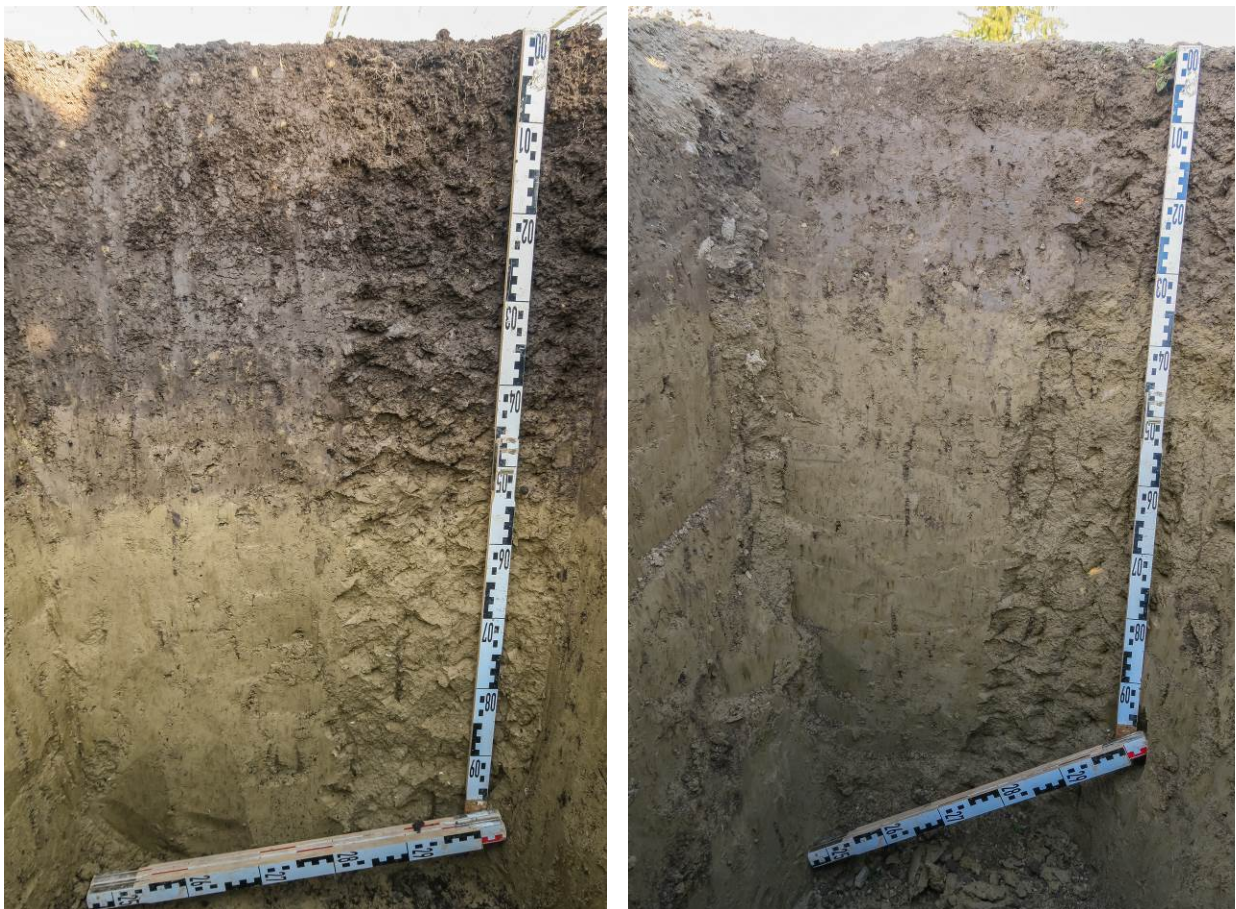
Abbildung 2: Bodenprofile am Standort 1. Gewächshausboden links, Boden der Referenzfläche rechts. An diesem Standort wurden beim Gewächshausbau keine Eingriffe in den Bodenaufbau gemacht und das Ausgangsmaterial ist auf beiden Flächen das gleiche.
