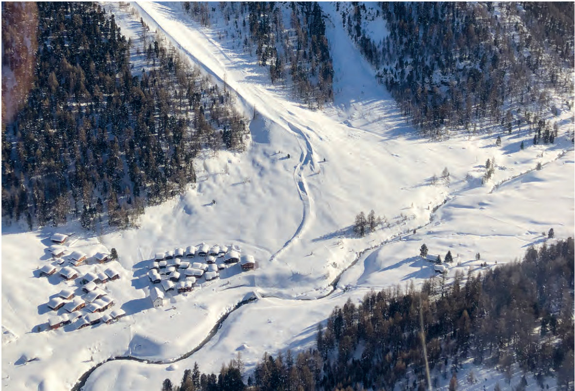
Abb. 88: Bei Meiden umfloss ein Lawinenarm das untere Ende des Ablenkdamms und kam erst 20 m vor dem Weiler zum Stillstand (Foto: Rinaldo Hugo, 29.01.2018).
