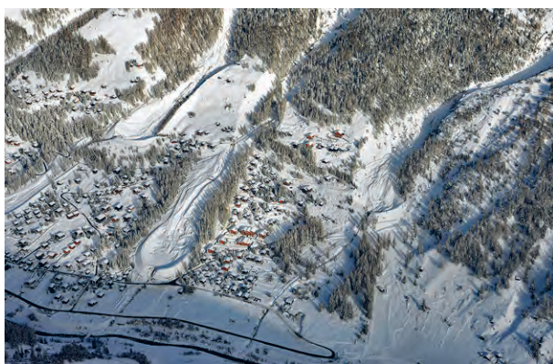
Abb. 126: In Zinal wurden in drei Lawinenzügen mit Auffangdämmen Lawinenniedergänge verzeichnet. Die Lawinen erreichten nur knapp den Dammfuss (Foto: P. Stoebener, 10.01.2018).
