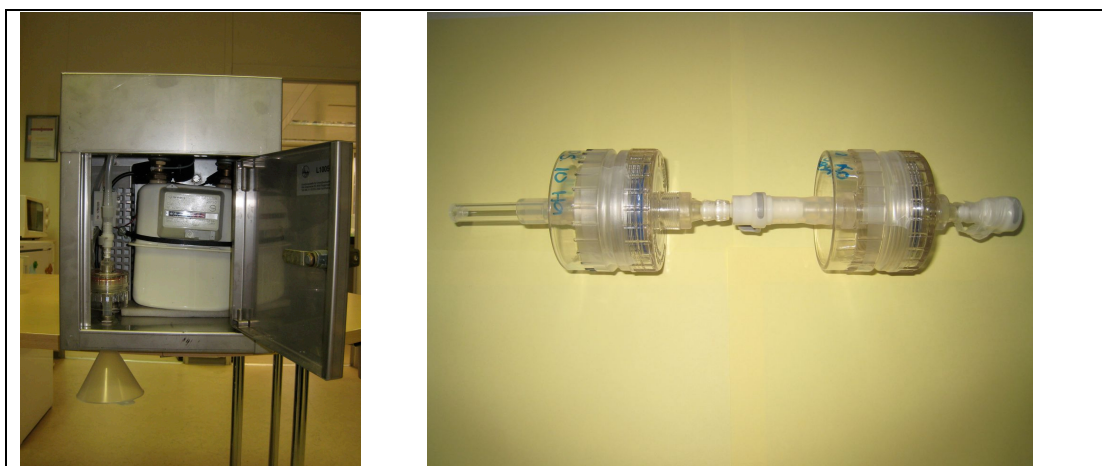
Abbildung 38 links: Offener Sufix, rechts: Summenfilter und Kontrollsummenfilter in Serie Probeneinlass, Summenfilter, ev. Kontrollsummenfilter, Gasuhr, Rotameter und Pumpe
