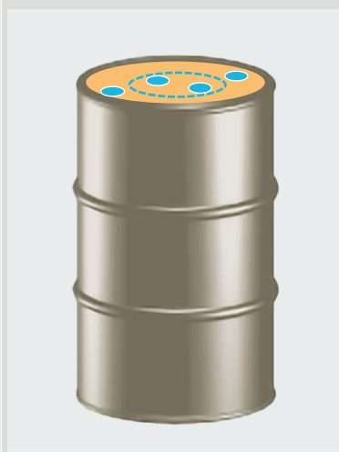
Abbildung 21: Probenahme aus einem Fass: Beispiel mit vier Einstichstellen
