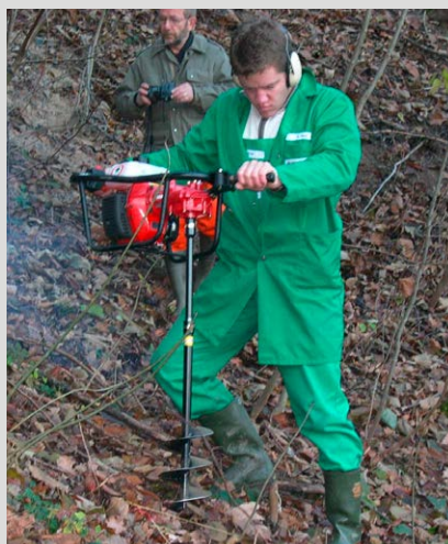
Abbildung 12: Probenahme mit Schneckenbohrer aus einer Abfallablagerung
