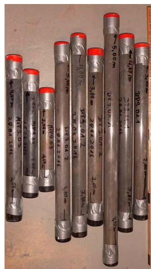
Abbildung 18: Feinkörnigen Feststoffproben mit leichtflüchtigen Stoffen in Kunststoff-Linern
