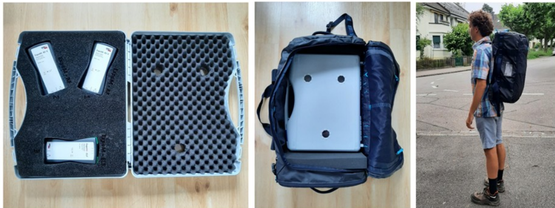
Abbildung 2: Darstellung des Setups für die Routenmessung. Links: Drei Messgeräte (zwei ExpoM-RF4 und ein ExpoM-ELF) sind in einem mit Schaumstoff gefüllten Koffer befestigt. Zentrum: Der Koffer wird in den Rucksack gestellt und mit Schaumstoff fixiert. Rechts: Die Messperson trägt den Rucksack mit den Messgeräten in einem Abstand von 20 cm zu ihrem Körper und in einer Höhe von 160 cm.
