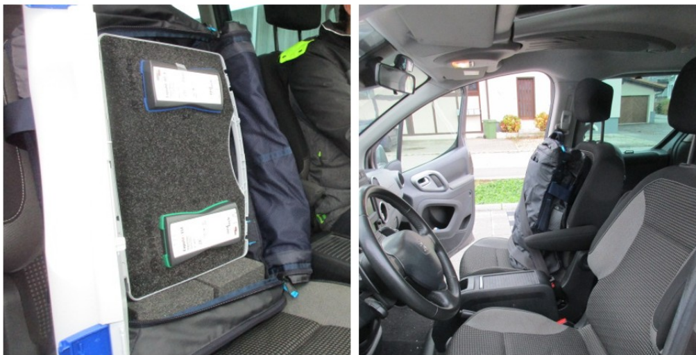
Abbildung 5: Darstellung des Mess-Setups für die zusätzliche Analyse in Autos. Für diese Messung wurden ein ExpoM-RF und ein ExpoM-ELF in den Messkoffer gelegt (links), der auf den Beifahrersitz gelegt wurde (rechts).
