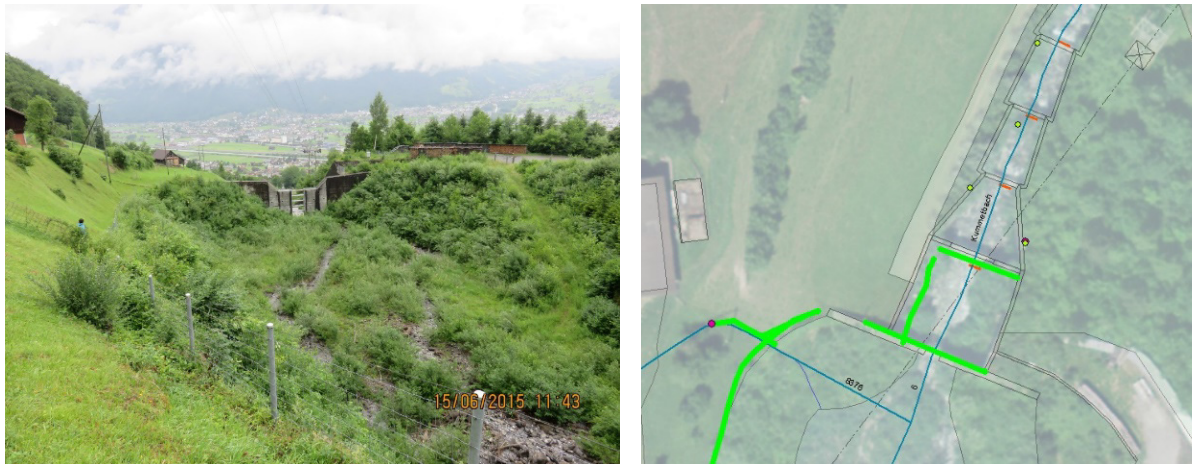
Abbildung 10: Erfassung der Werkgeometrie mit Digitalisieren ab Orthofoto.
