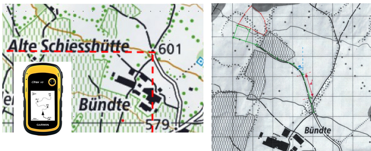
Abbildung 9: Erfassung der Werkgeometrie mit manuellem Einmessen ab Kartenpunkt.
