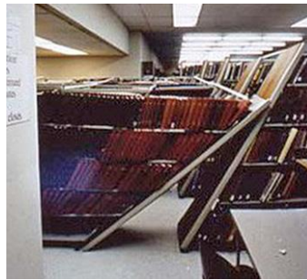
Abb. 2.22.1 und 2.22.2 > Versagensmechanismus in der Ebene («in plane») bei Regalen
