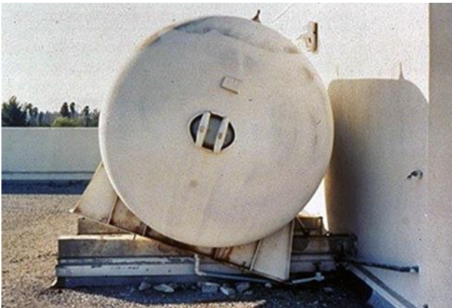
Abb. 2.17.1 und 2.17.2 > Trägheitsversagen bei Tankwänden
