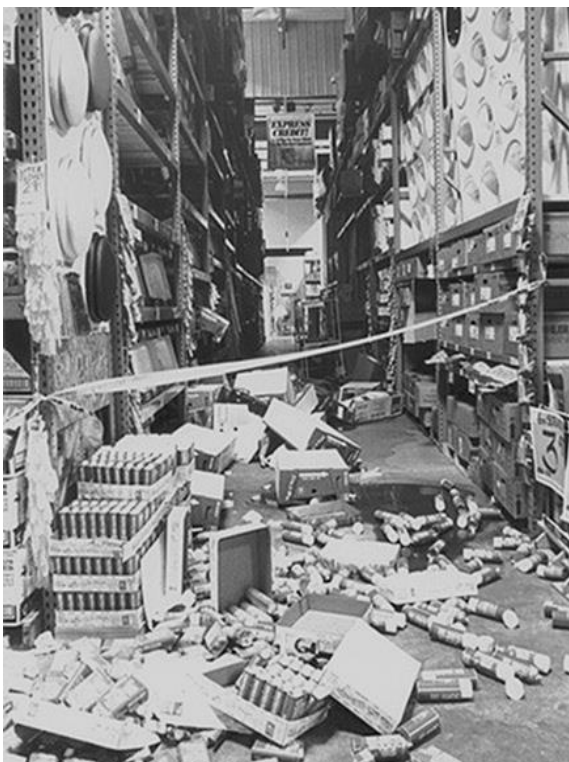
Abb. 2.23.4 und 2.23.5 > Beschädigtes Regal und herausgefallene Güter
