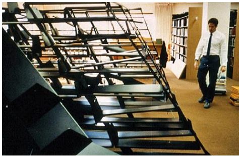
Abb. 2.22.1 und 2.22.2 > Versagensmechanismus in der Ebene («in plane») bei Regalen
