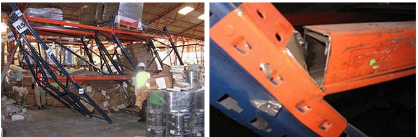
Abb. 2.23.6 und 2.23.7 > Versagen in der Ebene («in plane») infolge ungenügender Verbindung und Verankerung
