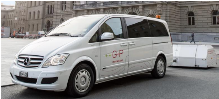
Abbildung 3: CPX Messfahrzeug mit Anhänger zur direkten Messung der Reifen-Fahrbahngeräusche
