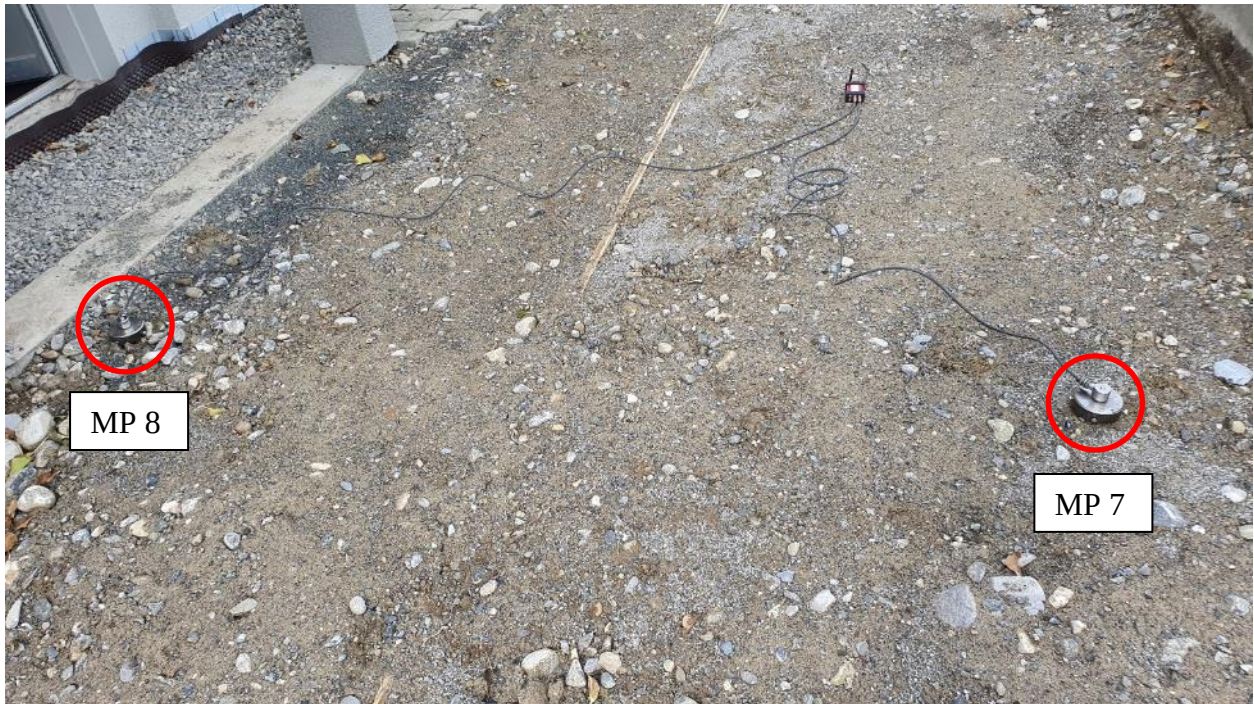
MP 8 Aussen hinten und MP 7 Aussen vorne: Vor dem Haus beim verfüllten Bodenschlitz
