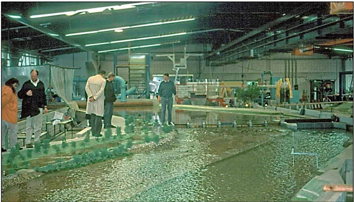
Abb. 22: Physikalisches Modell der Staustufe Rheinfelden mit Umgehungsgewässer und neuem Kraftwerk im Theodor Rehbock-Wasserbaulabor der Universität Karlsruhe im Jahr 1993
