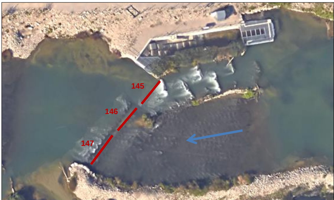
Abb. 29: Position der Seilantennen Nr. 145, 146 und 147 anstelle des Fischwehres
