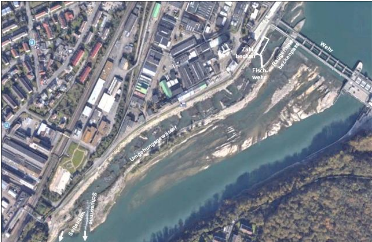
Abb. 23: Umgehungsgewässer mit zwei Ausläufen und dem zusätzlichen, wehrnahen Raugerinne-Beckenpass Rheinfelden (D)
