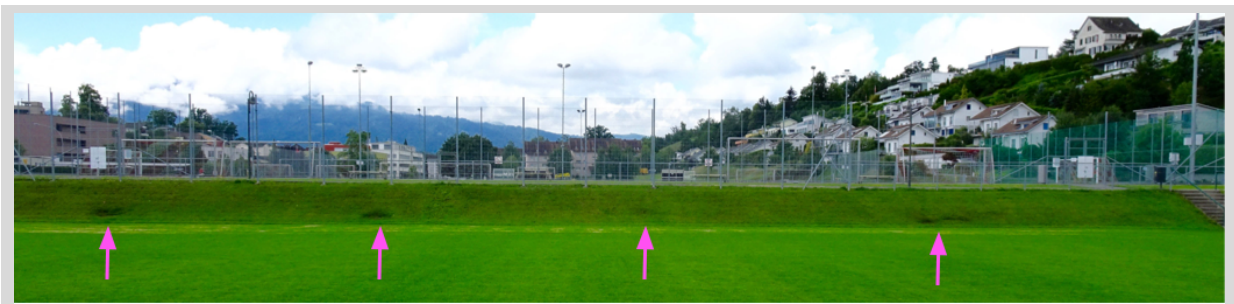
Abbildung 15: Gasaustrittsstellen (Volumenverhältnis \text{CH}_4 : \text{CO}_2 = 5:3 ) aus einer Siedlungsabfalldeponie, welche während 30 Jahren bis 1971 betrieben wurde. Die Austrittsstellen zeigen auch im Jahr 2020 noch Vegetations-Schäden durch Deponiegas. Die regelmässige Anordnung in der Böschung ergibt sich aus der Lage von Sickerwasserleitungen, welche zur Entwässerung des Trainingsplatzes dienen. Das Deponiegas diffundiert aus der Deponie in die Sickerwasserrohre im aufgeschütteten Material und von diesen an die Oberfläche.
