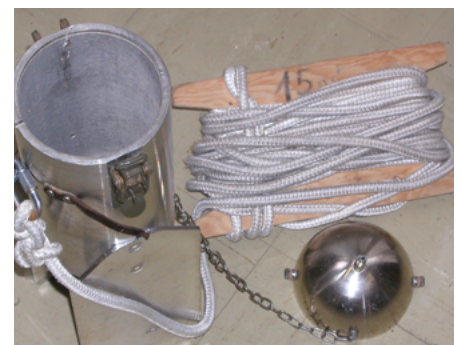
Bild 1a: Probenahme Schwebstoffsammler am Seil. Foto: A. Grasso.
