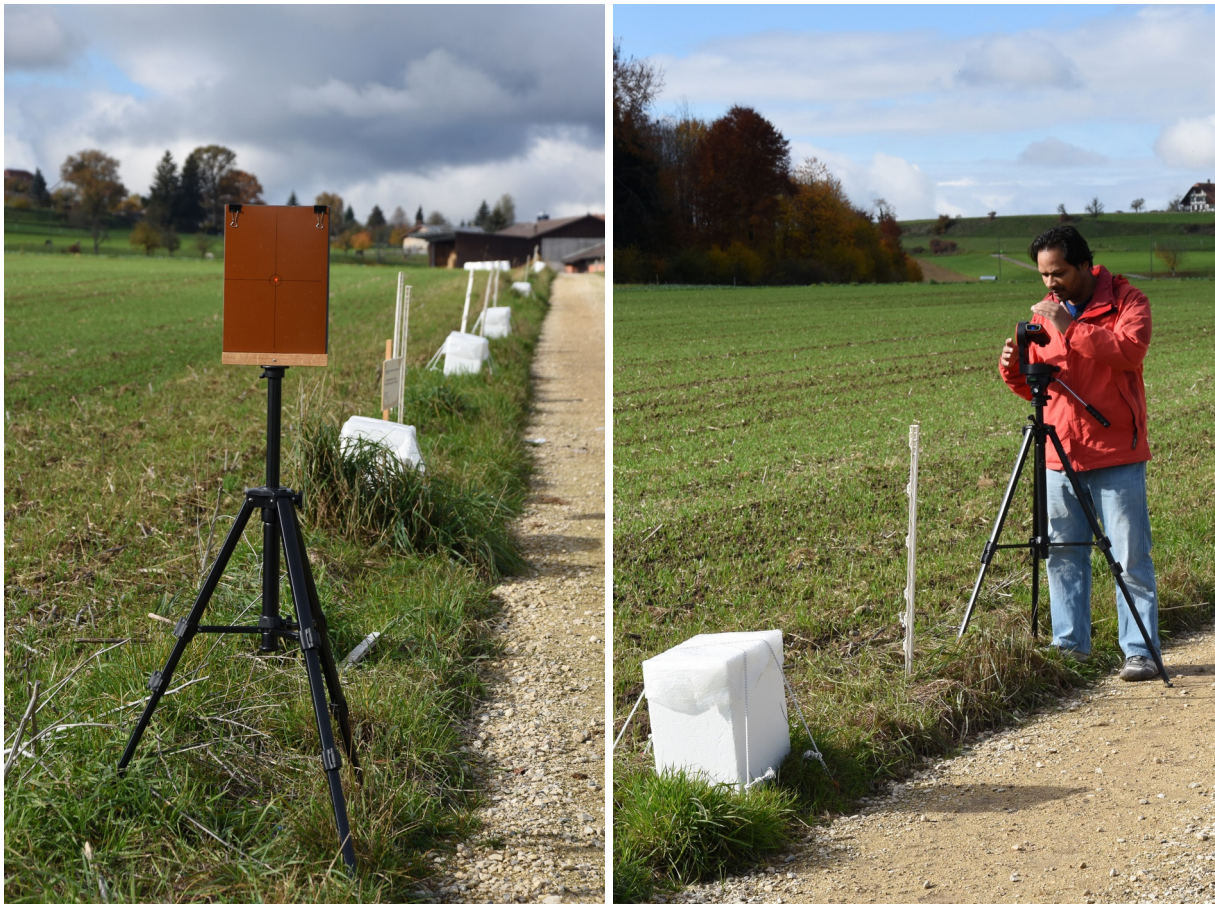
Abbildung 14: Links die anvisierte Laser-Zieltafel, rechts das Anvisieren des Leiterseils mit dem DISTO D510.
