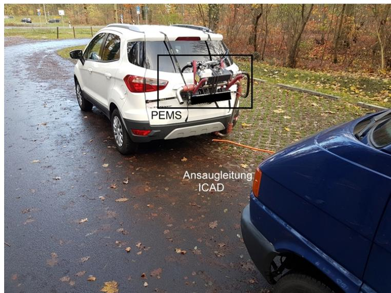
Abbildung 60: Aufbau für Vergleichsmessung an einem EURO 6 PKW.
