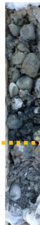
A l'image du PR2, les déchets humides, avec des venues d'eau, sont en contact direct avec les dépôts perméables
