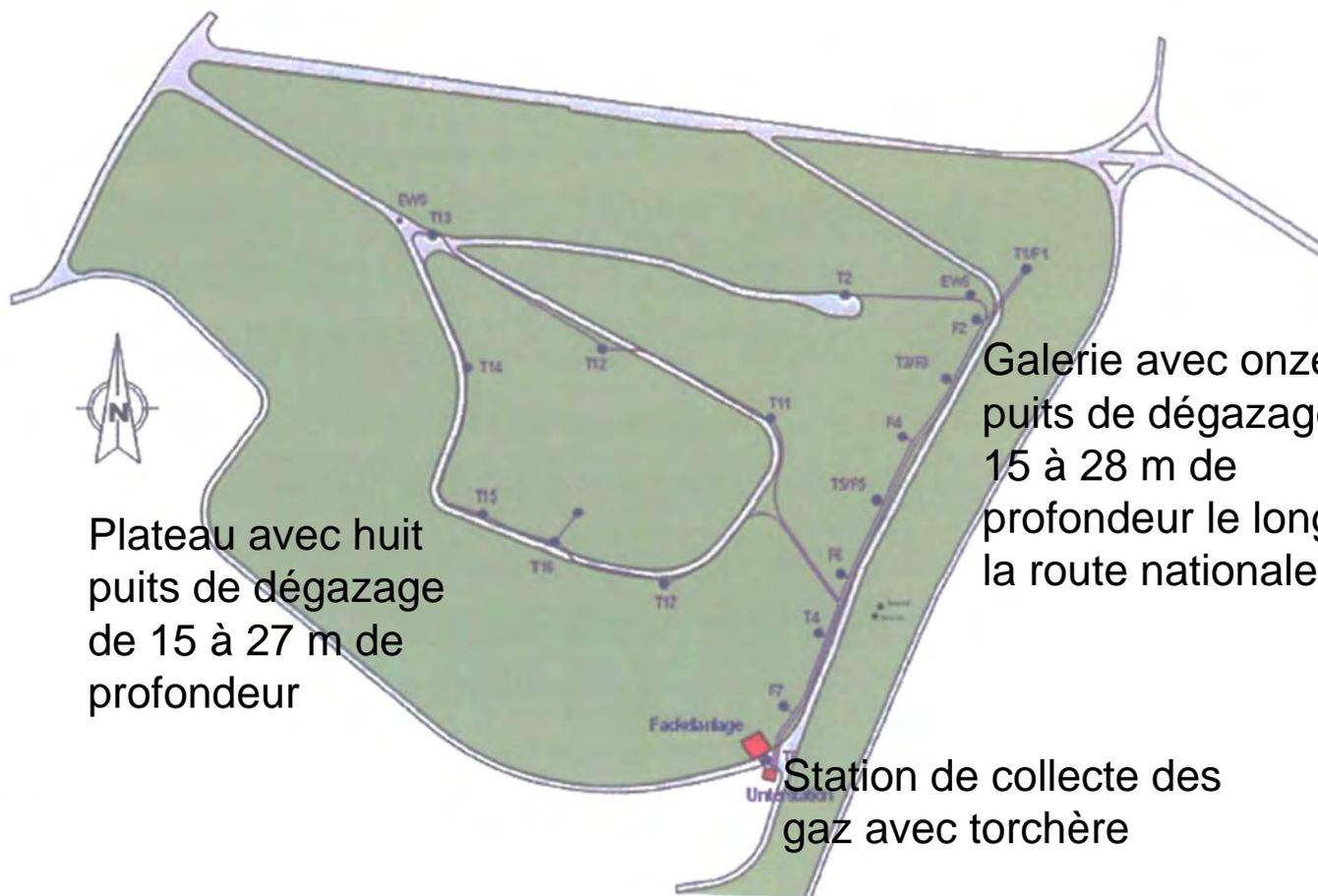
Plateau avec huit puits de degazage de 15 à 27 m de profondeur
