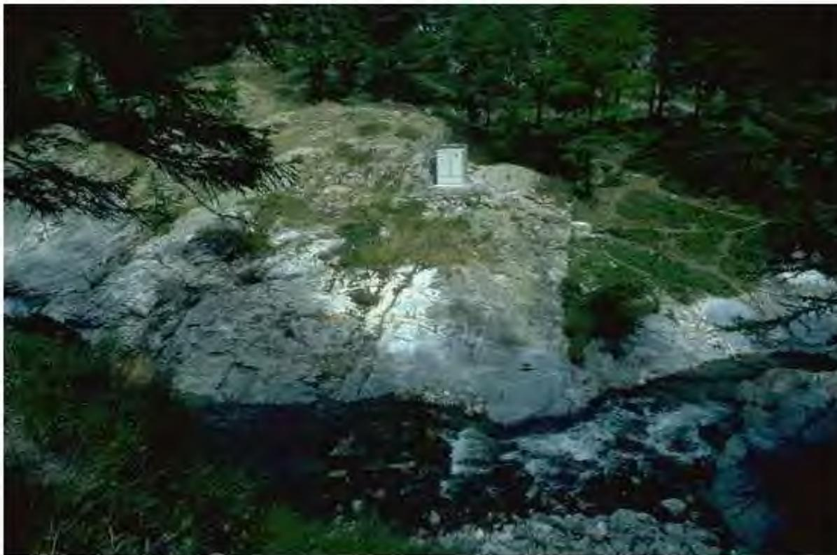
*Abbildung 96: Messstation BAFU 2244 Krumbach - Klusmatten Blick auf die Felsplatte mit der Messkabine und dem Bach davor. Die Pegelmessung befindet sich senkrecht unterhalb der Kabine (BAFU 2021).*
