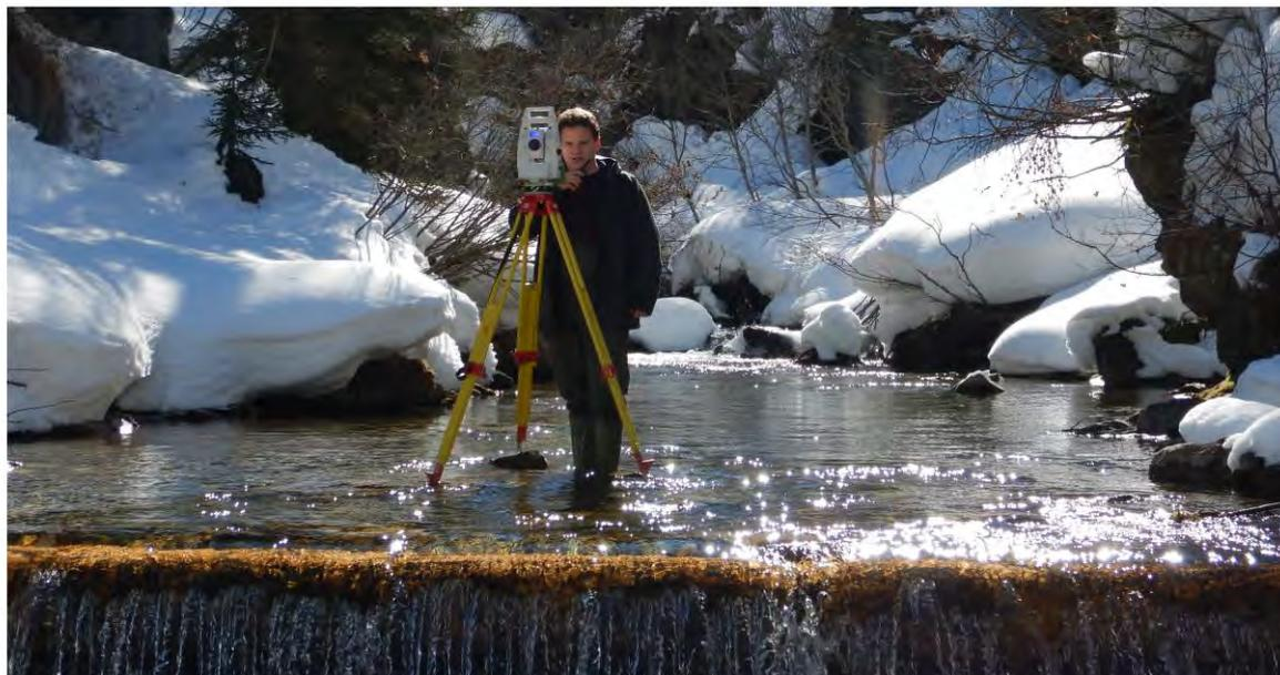
*Abbildung 170: Dischmabach, Vermessung der Geometrie mit einem Tachymeter von einem festen Standort oberhalb des Überfalles ins Vorbecken am 14.03.2022 (Bild R.Kaderli)*
