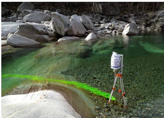
Fig. 39 : Trace du colorant lors d'une mesure au moyen d'un traceur fluorescent.
