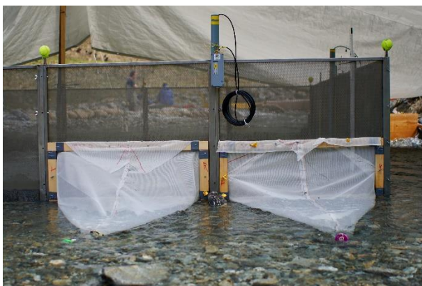
Abb. 24 und Abb. 25: Die Driftreusen der Versuchsreihe 2 (Bilder: Reuther und Ravessoud).
