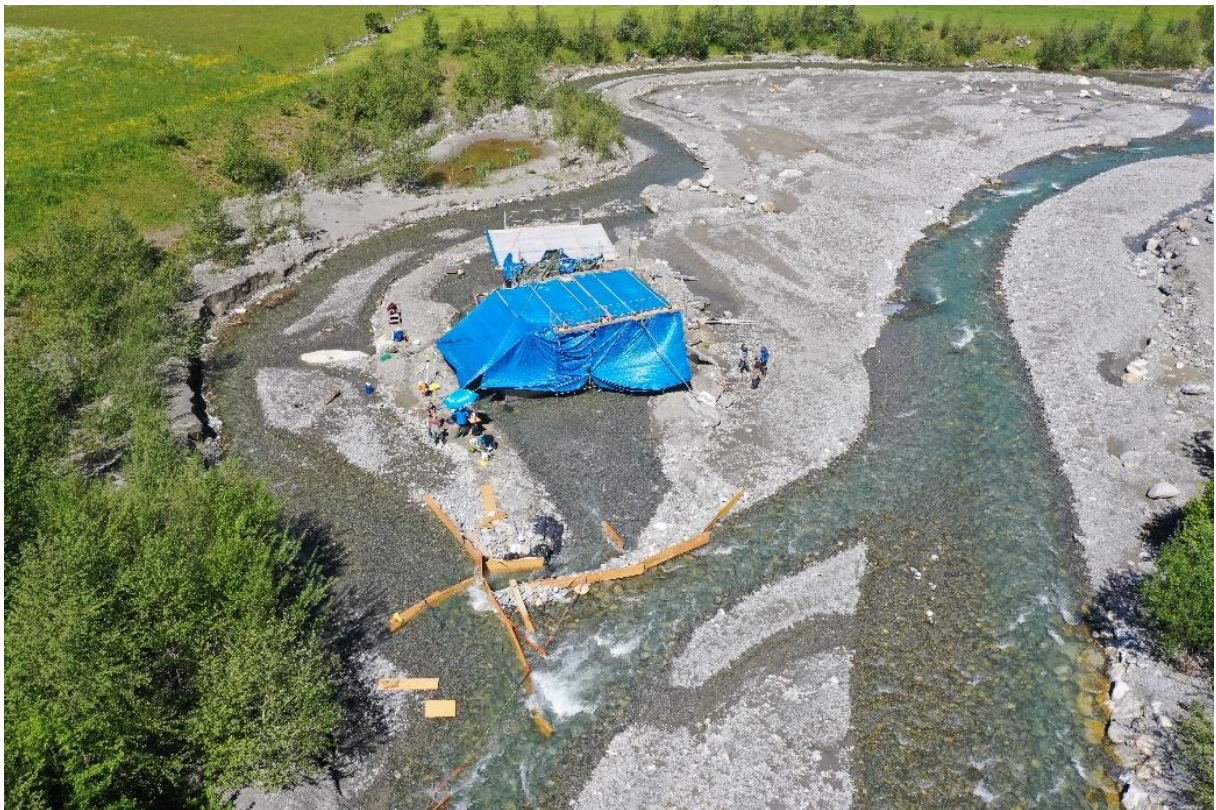
Abb. 2: Versuchsanlage und Regulierbauwerk der Strandungsversuche 2021 im Geschiebesammler oberhalb der Gemeinde Innerkirchen.
