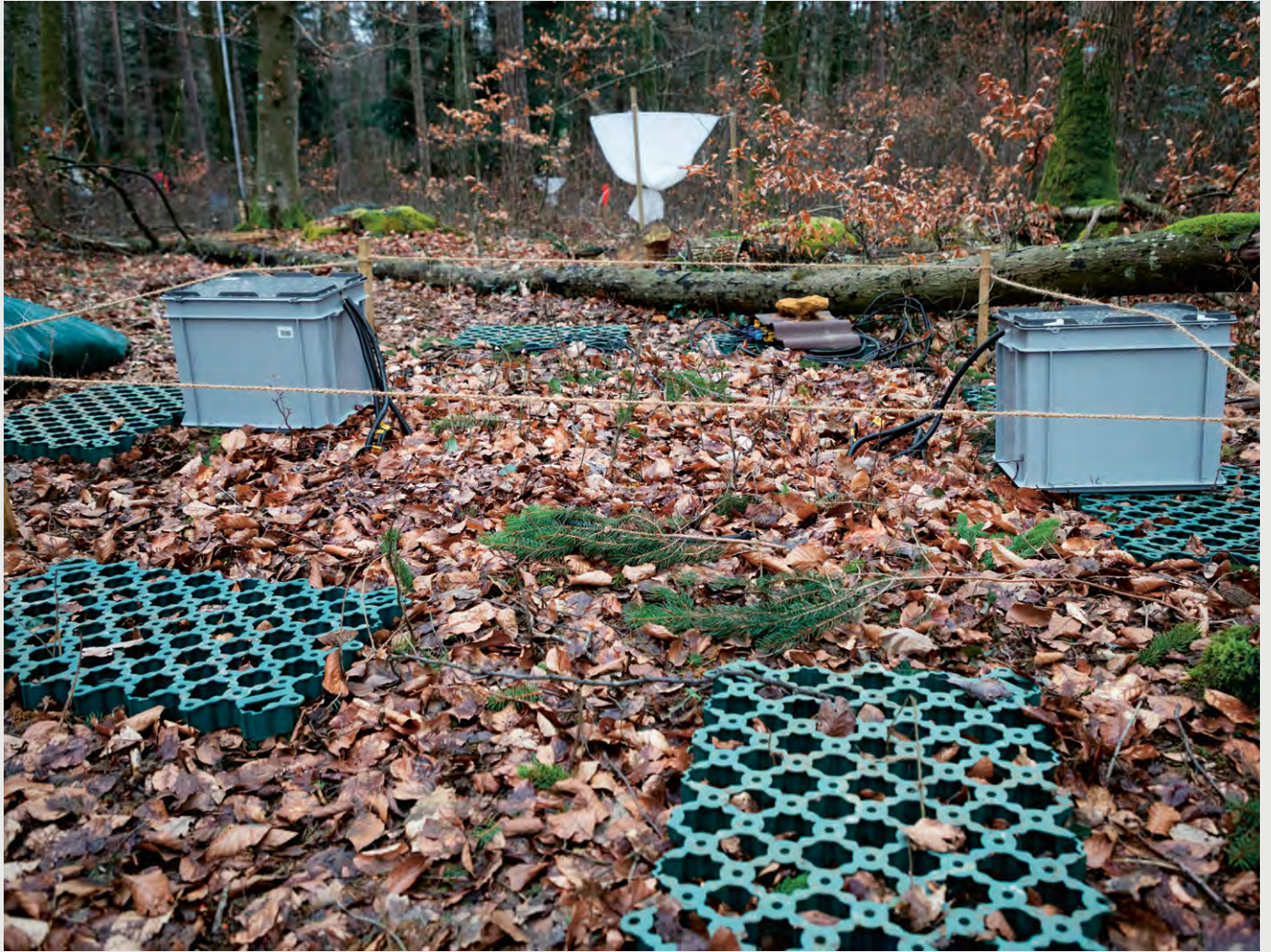
Expérience à long terme à Hölstein (BL), le 13 mars 2018. L'université de Bâle entend observer, sur une surface de près d'1,5 ha et pendant 20 ans, les effets de la sécheresse sur la forêt locale. À cette fin, la moitié de la surface de sondage est recouverte d'un abri contre la pluie afin de simuler des conditions sèches.
