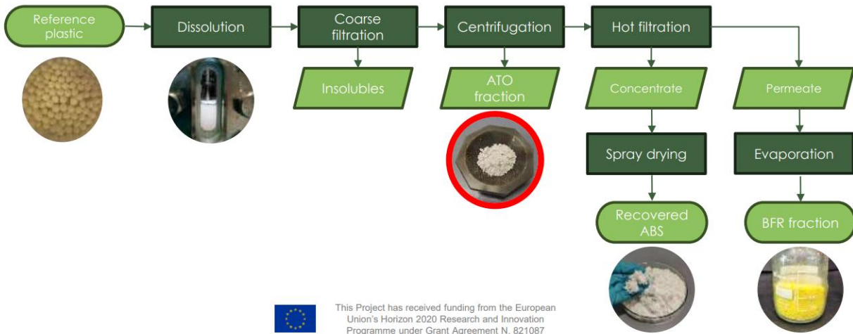
Abbildung 13: Prozessübersicht für die Rückgewinnung von ATO, ABS und BFR. Quelle: Plast2bCleaned, 2020 [54].
