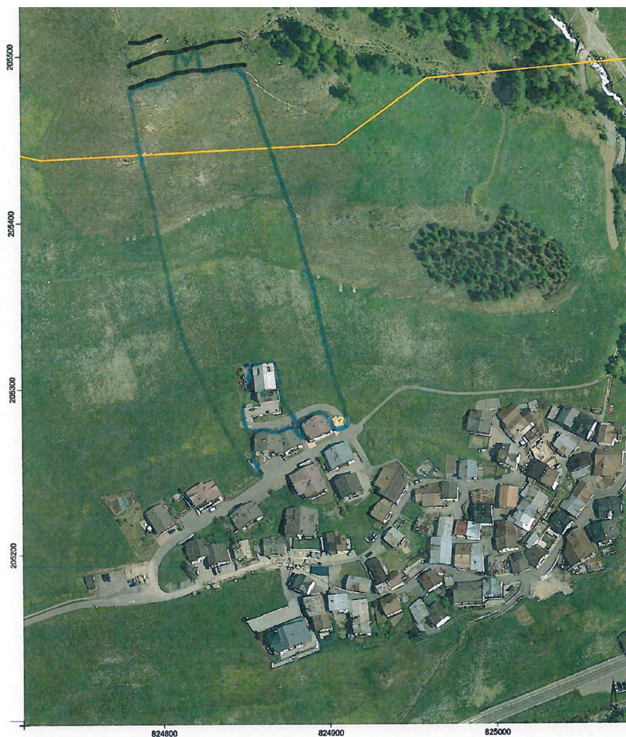
Fig. 100: À Samnaun Laret, une avalanche se déclenche sous une zone équipée d'ouvrages de retenue, et atteint des bâtiments d'habitation.
