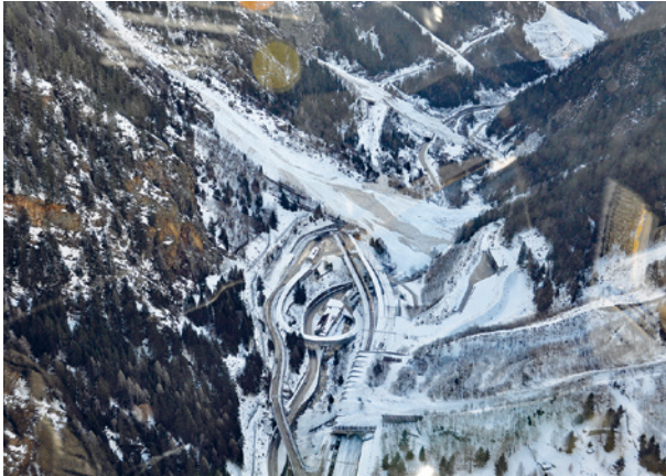
Fig. 132: Dans la région de Goppenstein, pratiquement toutes les galeries ont connu un déversement d'avalanche. Toutefois, en comparaison avec l'hiver avalancheux de 1999, les dépôts d'avalanche ont été beaucoup plus petits (photo: SLF/S. Margreth, 24.01.2018).
