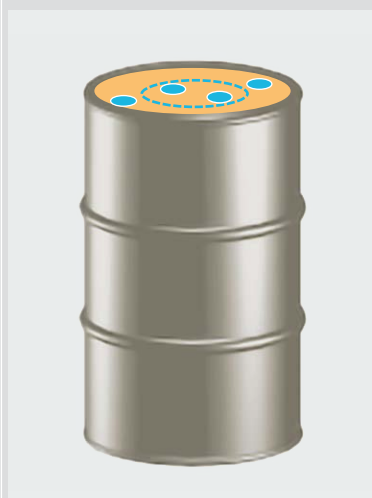
Figure 21 : Prélèvement d'échantillons dans un fût : exemple avec quatre sondages
