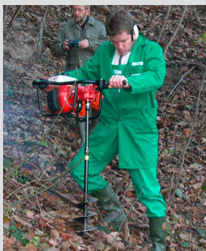
Figure 12 : Prélèvement d'échantillons dans une accumulation de déchets au moyen d'une tarière hélicoïdale
