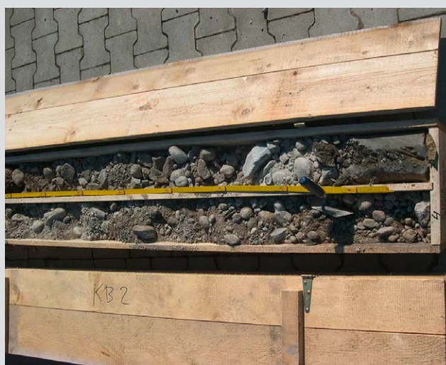
Figure 15 : Boîtes de forage contenant des matériaux à grain grossier prélevés dans le cadre d'un carottage de 4½" de diamètre
