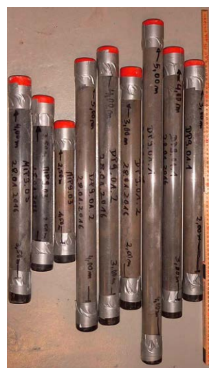
Figure 18 : Échantillons solides de matériaux à grain fin contenant des substances volatiles stockés dans des liners en plastique
