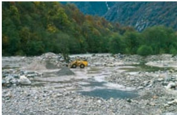
Dans les zones alluviales, l'extraction devrait être limitée à la quantité qui se dépose naturellement dans le site: Brione Verzasca, TI (Photo: Service conseil Zones alluviales).
