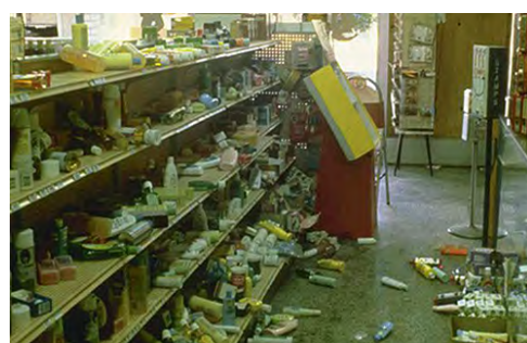
Fig. 2.22.7, 2.21.8 et 2.22.9 > Dégâts malgré des étagères intactes
