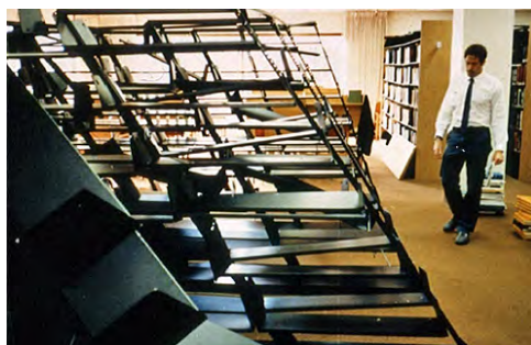
Fig. 2.22.1 et 2.22.2 > Mécanisme de ruine dans le plan («in plane») pour des étagères
