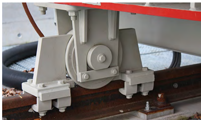
Fig. 2.14.4 > Fixation au moyen de deux sabots d'arrêt par roue
