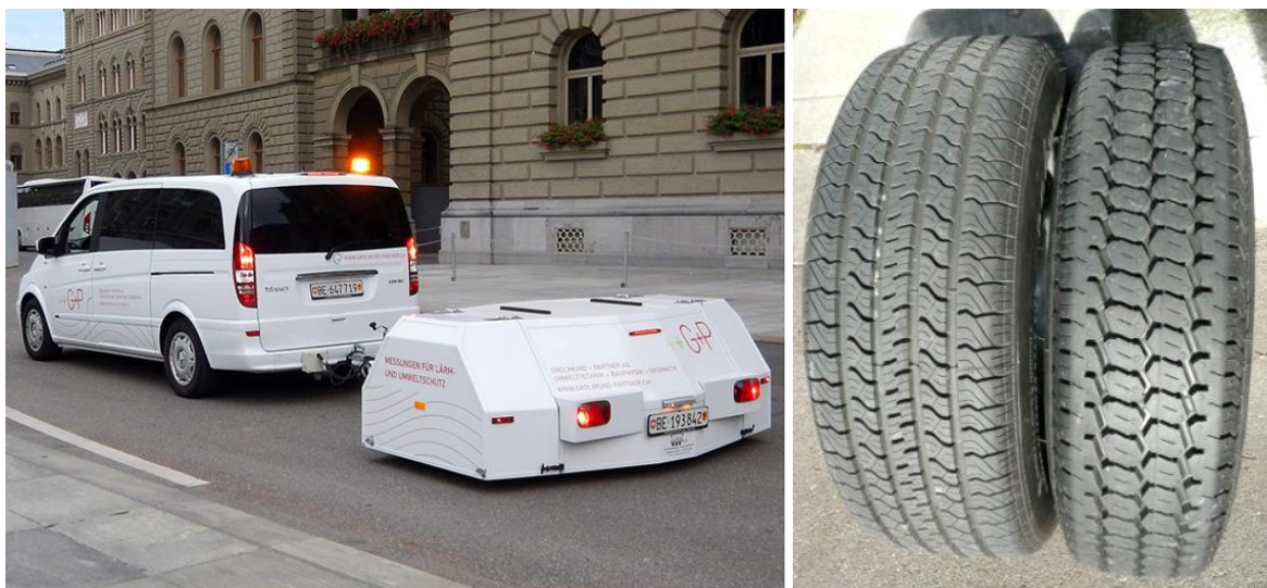
Abbildung 1: G+P Messsystem und CPX-Testreifen P1 (links) und H1 (rechts) gemäss SN EN ISO 11819-2:2021.
