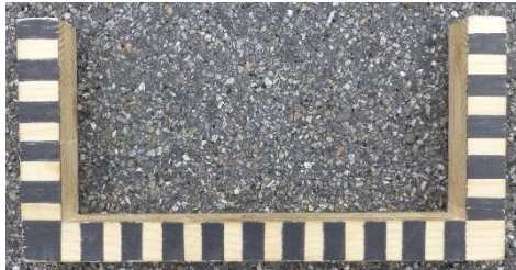
Latterbach, Hauptstrasse, SDA 4 2018 ohne Fasern
