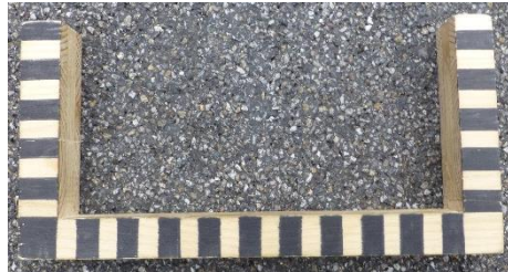
Latterbach, Hauptstrasse, SDA 4 2018 mit Fasern
