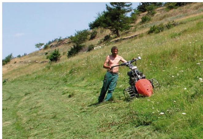
Fig. 35 > Falciatrice a lama orizzontale (barra falciante)
