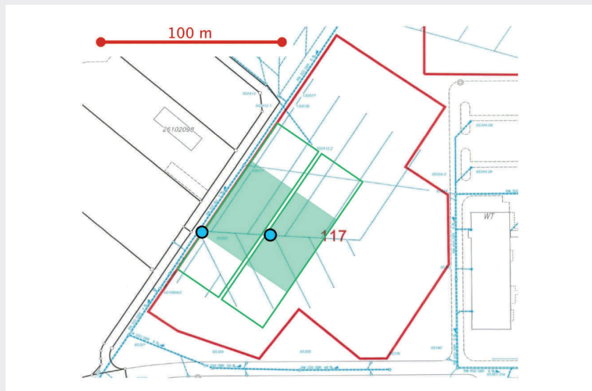
Fig. 2 Versuchsfelder an der Agroscope ART (Standort Reckenholz) für Emissionsstudien aus der Landwirtschaft. Drainageröhren und Standorte der Probenahme in Blau, Grün umrandet die beiden Teilfelder mit den effektiv drainierten Flächen (grün). Rechts im Bild der Westflügel der Forschungsanstalt Agroscope ART
