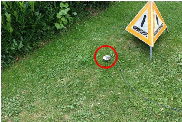
MP1 Referenzmesspunkt, 8 m ab 1. Gleisachse
