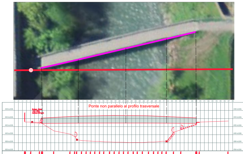
Fig. 25 Proiezione del ponte nel profilo trasversale.
