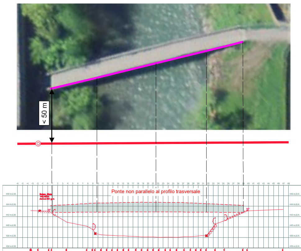
Fig. 26 Proiezione di un ponte in un profilo trasversale distante meno di 50 m.
